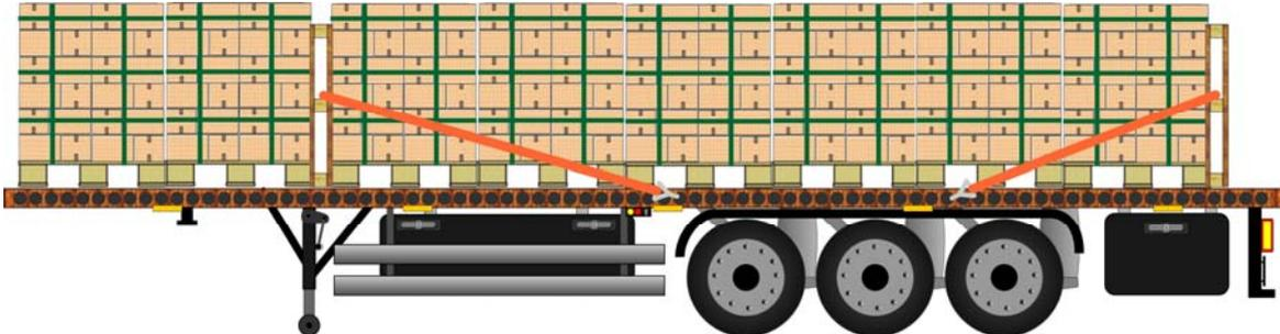
Um eine Ladung ausschließlich durch Niederzurren zu sichern ist eine unverhältnismäßig hohe Zahl an Zurrmittel notwendig. Alternativ müssten Zurrmittel mit deutlich höheren Vorspannkraften ( $S_{TF}$ ) eingesetzt werden, was zwangsläufig zu einer Beschädigung des Ladegutes führt würde.
