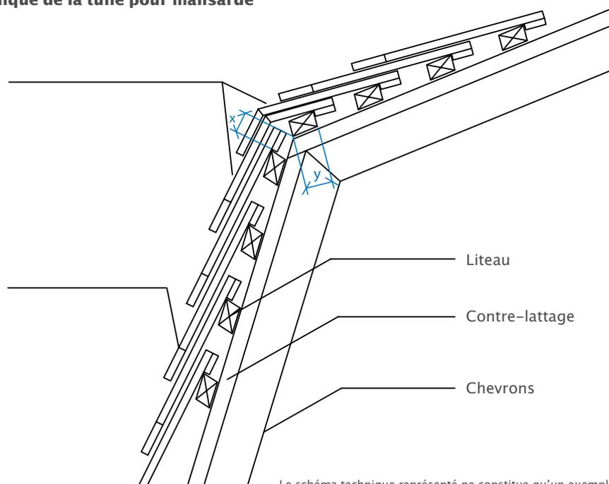
Le schéma technique représenté ne constitue qu'un exemple de construction
