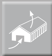
Gebäude mit Windinnendruck und offener Deckunterlage bzw. Unterspannung
