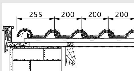
Rive de toit gauche avec bande de rive et tuile double bourrelet
