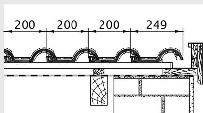
Rive de toit droite avec bande de rive et tuile de couverture
