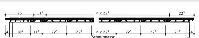
Querschnitt mit Bord- und Flächenziegel
