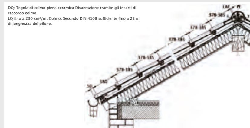
DQ: Tegola di colmo piena ceramica Disaerazione tramite gli inserti di raccordo colmo.
