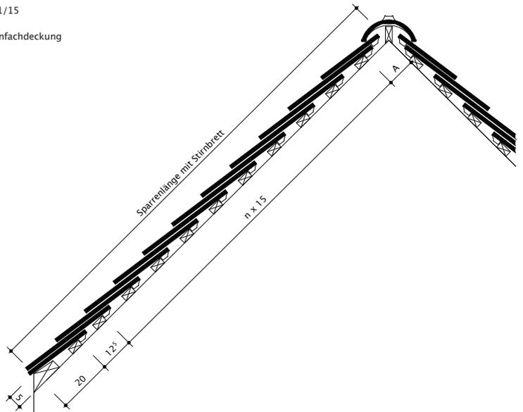
Minimale Dachneigung Unterdach mit
