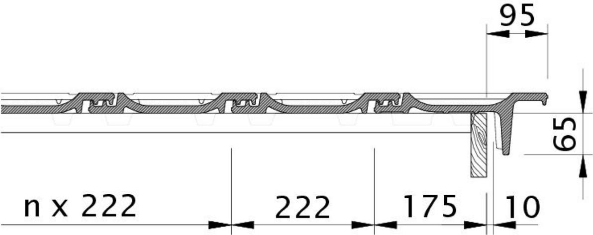
Zeichnung OPTIMA Ortgangziegel rechts mit Ortgangbrett OBR
