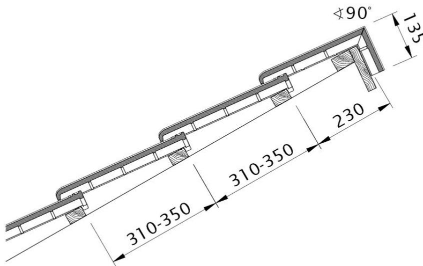
Zeichnung MAXIMA PRO Pulldach-Ausführung PDA
