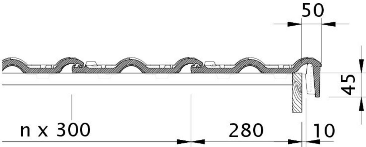
Zeichnung MAXIMA PRO Ortgangziegel rechts mit Ortgangbrett OBR
