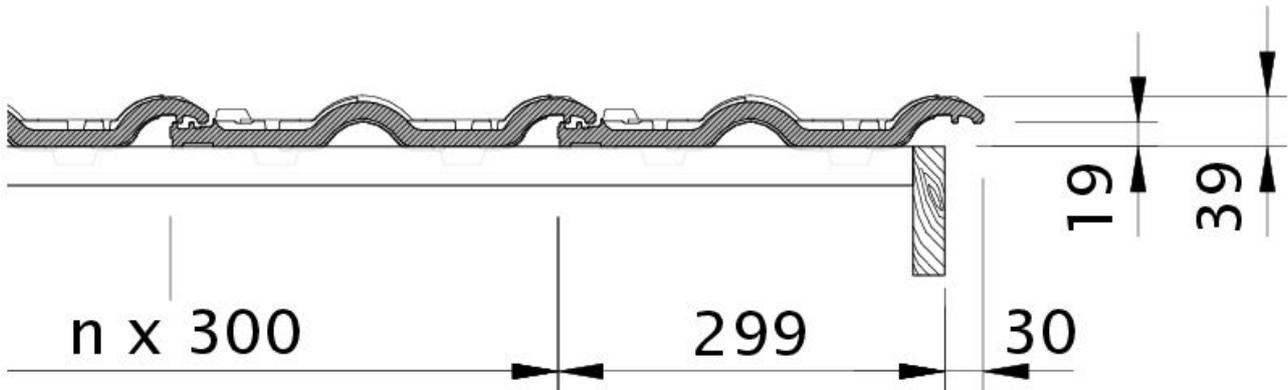
Zeichnung MAXIMA PRO Ortgang rechts mit Ortgangblech und Flächenziegel OFR
